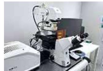
最新の共焦点レーザー顕微鏡[LSM-900 Airyscan2]。様々な蛍光標識色素に対応し、従来よりも高感度な観察が可能になりました。Airyscan2とデコンポリューションによる超解像イメージングを実現します。
